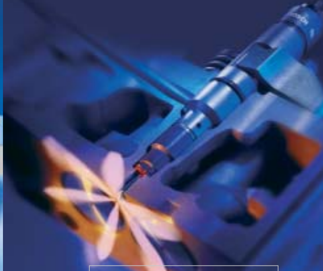
Injector van een dieselmotor: Toekomstige systemen zullen van een enkele tientallen nanometers dikke diamantachtige slijtbeschermingslaag worden voorzien.
