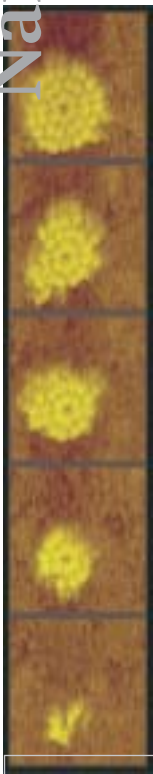
Een siliciemeilandje op een siliciumkristal lost bij 450 °C langzaam op. Inzicht in dergelijke verschijnselen is belangrijk voor de kwaliteit van dunne films.
