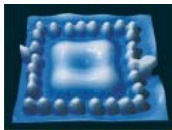
Mangaanatomen op zilver, aan de Christian-Albrechts-Universiteit van Kiel. Het distributiepatroon van de door het hek van mangaanatomen ingesloten elektronen is afhankelijk van de aangelegde elektrische spanning. Dergelijke effecten zijn van belang voor de elektronica van morgen.
