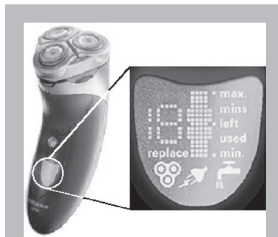
Figuur 1: Een monochroom gesegmenteerd poly-LED beeldscherm, dat op een Philips scheerapparaat wordt gebruikt als indicator voor de status van de batterij. Dit is het eerste commerciële poly-LED product voor de consumentenmarkt (juni 2002).
