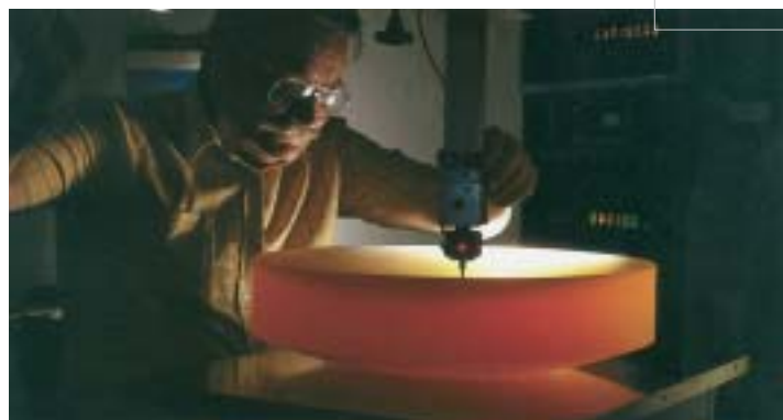
Zerodur voor lithografiemaskers, dit speciale keramische product is zelfs op nanoschaal vormstabiel.
