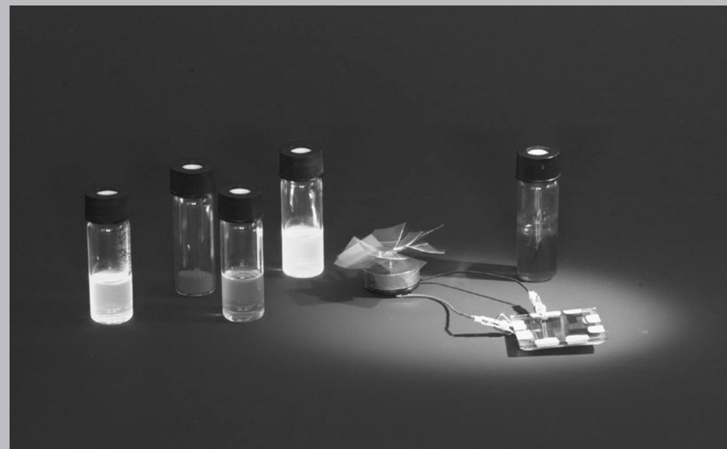
Prototype van een polymeren zonnecel, ontwikkeld door de TU/e in samenwerking met de RuG en ECN. De potjes om de zonnecel heen bevatten de polymeren die in de actieve laag van de zonnecel worden gebruikt.
