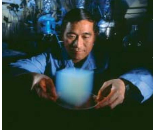
Aërogeel als wetenschappelijke stofzuiger. Ingevangen deeltjes worden veilig ingesloten in een gesmolten aërogeelmasse.
