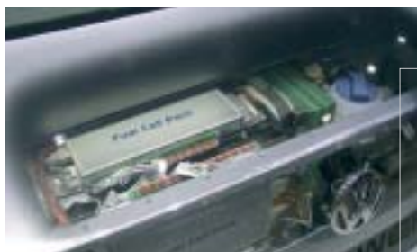
Dankzij brandstofcellen (zie blz. 33) wordt de auto schoner in gebruik. Wanneer de waterstofhoudende brandstof nu ook nog uit duurzame energiebronnen komt, is deze vorm van aandrijving uitgesproken milieuvriendelijk.
